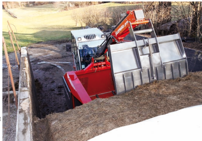
Maximal erreichte unsere Testmaschine Silage in 3,20 m Höhe. Je höher, desto weniger Kraft bleibt für das Herunterdrücken.
