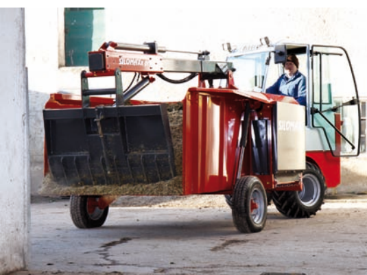
Das Knickgelenk macht die Maschine gelenkig. Trotzdem ist der Wenderadius groß. Ungewohnt zu Fahren: die Breite Wanne mit dem schmalen Hinterwagen.
