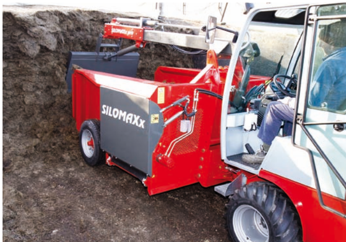
Der Teleskoparm fährt um 1 m aus. Die Reißzinken am Schild kämmen die Grassilage aus dem Silo.
