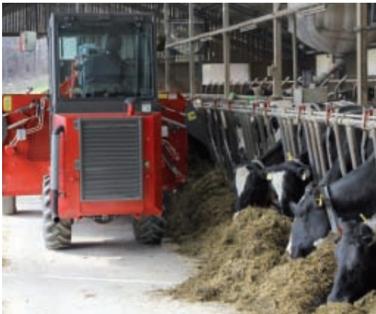
Der Silomaxx legt das Futter nahe und locker am Futtertisch ab.
